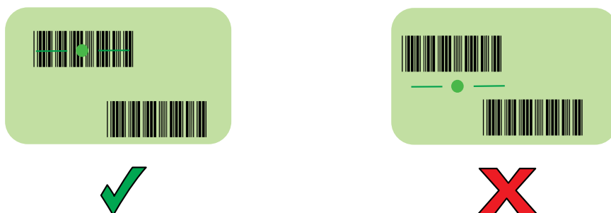
Bild 7 SE55 vill skapa plocklisteläge med flera streckkoder
