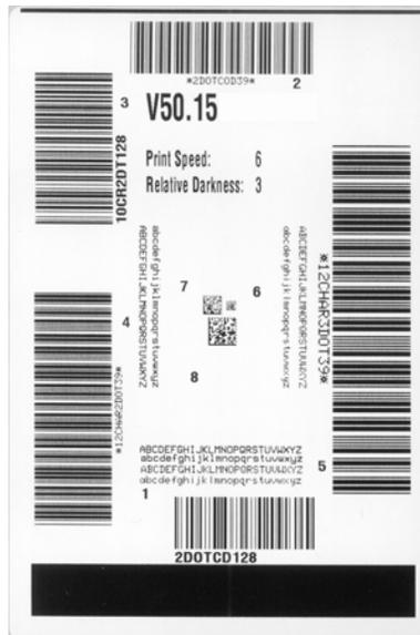
4. 그림 21 및 표 21을 참조하십시오. 테스트 라벨을 확인하여 어떤 것이 응용 프로그램에 가장 적합한 인쇄 품질인지 결정합니다. 바코드 확인 장치가 있는 경우, 이를 사용하여 바/공백을 측정하고 인쇄 명암을 계산합니다. 바코드 확인 장치가 없는 경우, 눈으로 확인하거나 시스템 스캐너를 사용하여 자가 테스트에서 인쇄된 라벨을 바탕으로 최적의 농도 설정을 선택합니다.
