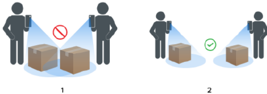
Figure 10 Dimensionnement à l'aide de plusieurs terminaux
