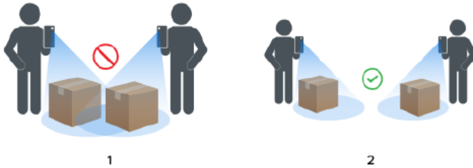
Figura 10 Dimensionamiento con varios dispositivos
