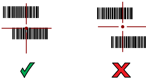
Figura 20 Modo Pick List (Lista de selección) del RS5100 con varios códigos de barras en un patrón de enfoque
