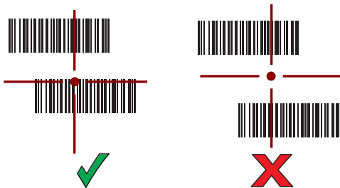
Figura 14 Modo de lista de selección del RS507/RS507X con varios códigos de barras en un patrón de enfoque
