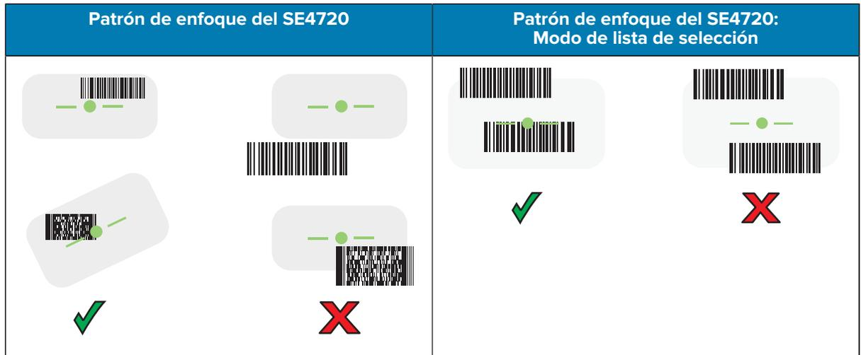
De forma predeterminada, el LED de captura de datos se ilumina de color verde y emite un sonido para indicar que se decodificó correctamente el código de barras.
