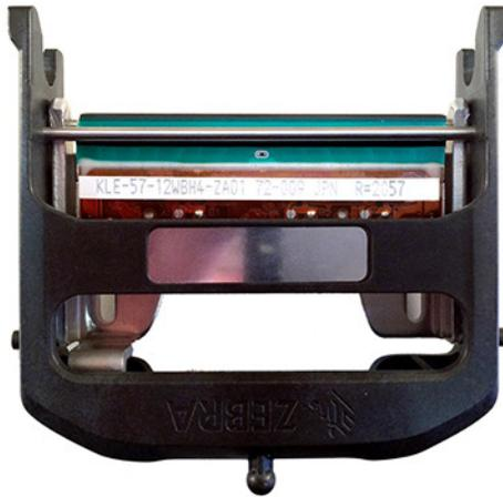
3. Setzen Sie das zur Stabilisierung gedachte Kugelgelenk in das entsprechende Fach in der oberen Abdeckung ein.
